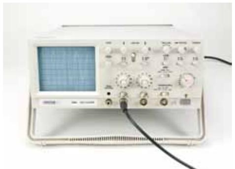
**16512 Osciloscopio analógico 2x30MHz**
