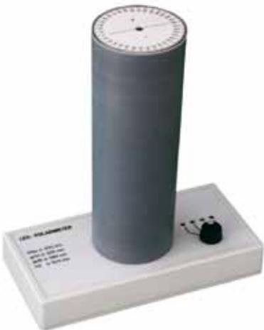
**14610 Polarímetro de LEDs**
