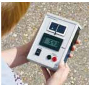
**13595 Medidor de irradiación solar**
