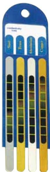
**13128 Dispositivo medición conducción térmica**
