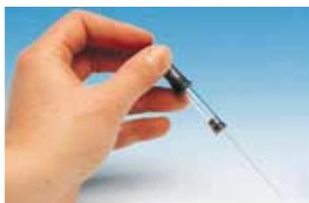
**18630 Microcapilares 1μl (50x)****18640 Soporte para microcapilares**
