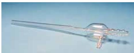
**23610 Trompa de agua para vacío**
