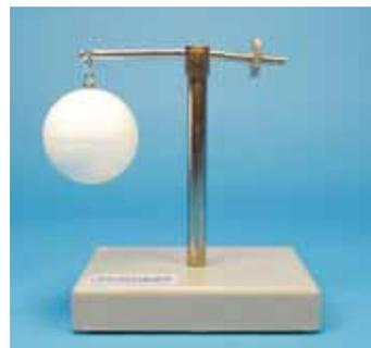
**11728 Balanza de Arquímedes para vacío**
