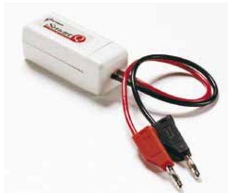
**Sensores de voltaje y corriente**
