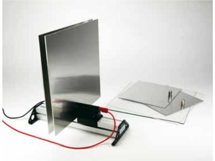
**15227 Condensador de placas regulable**
