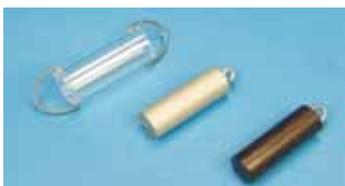
**11638 Tubo con cilindros principio Arquímedes**
