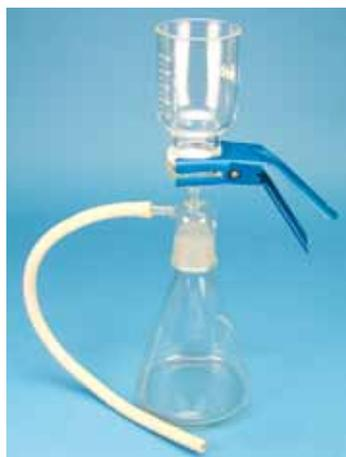
**18160 Montaje para filtración**
