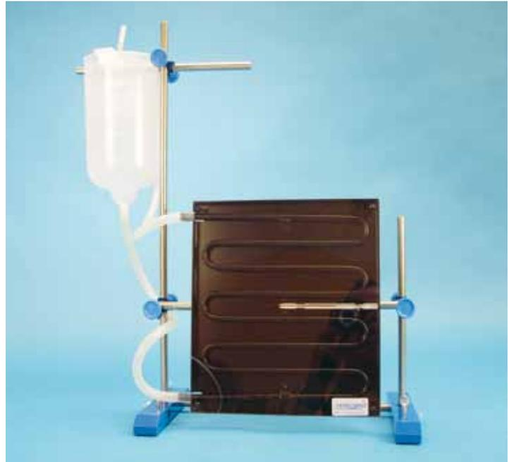
**13570 Colector solar térmico plano**
