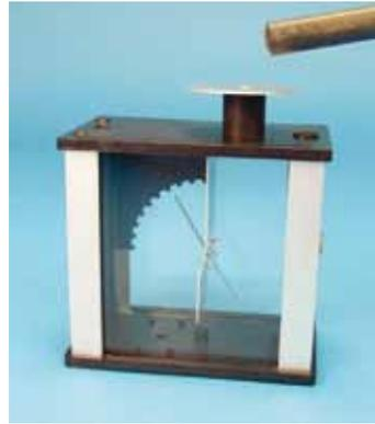
**15216 Electroscopio con escala**
