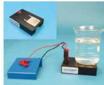
**13287 Modulo Energía Termoeléctrica**
