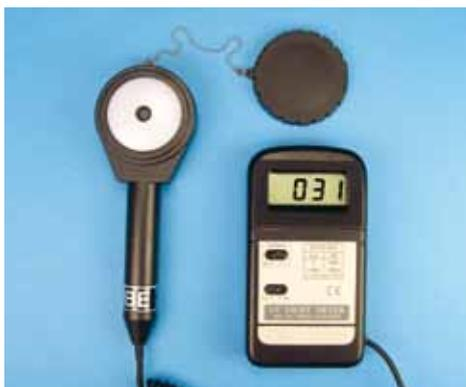
**51516 Medidor de radiación ultravioleta**
