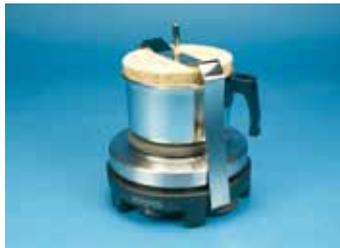
**13146 Generador de vapor con placa calefactora**
