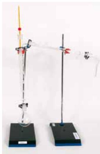
**18157 Montaje de destilación fraccionada**
